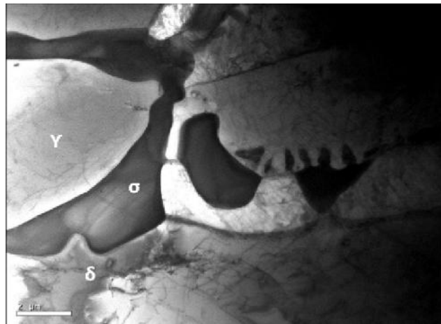
Figure V.3. Micrographie électronique à transmission du duplex 2205 traitée à 1150°C pendant 1 heure et vieillie à 850 ° C pendant 4 heures.
