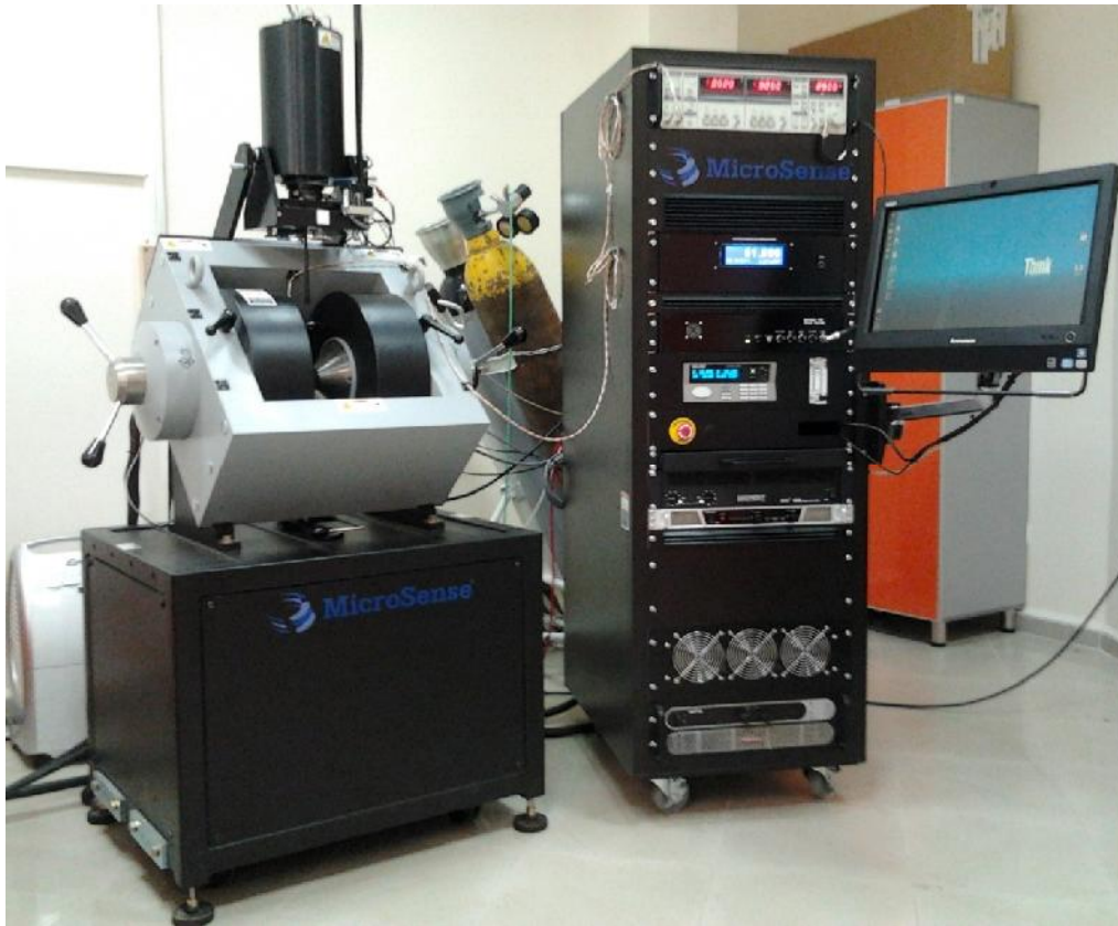
FigureIV.8 Magnétomètre à échantillon vibrant VSM
