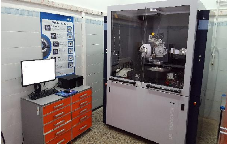
Figure.IV.24.Diffractomètre du type BRUKER Discover D8
