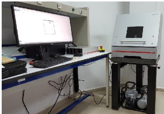
Figure.IV.25. appareil de Nanoindentation Anton Paar AE TTX
