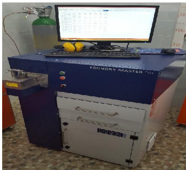
Figure.IV.1 Appareil d'analyse chimique à étincelle
