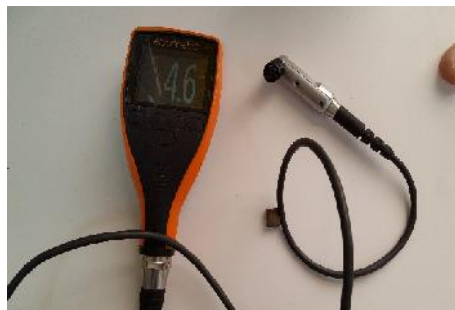
Figure IV.10. Appareil de mesure d'épaisseur par induction magnétique.
