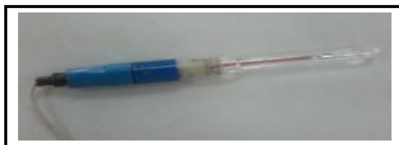
Figure (III.4) : l'électrode de référence au calomel saturé en KCl.
