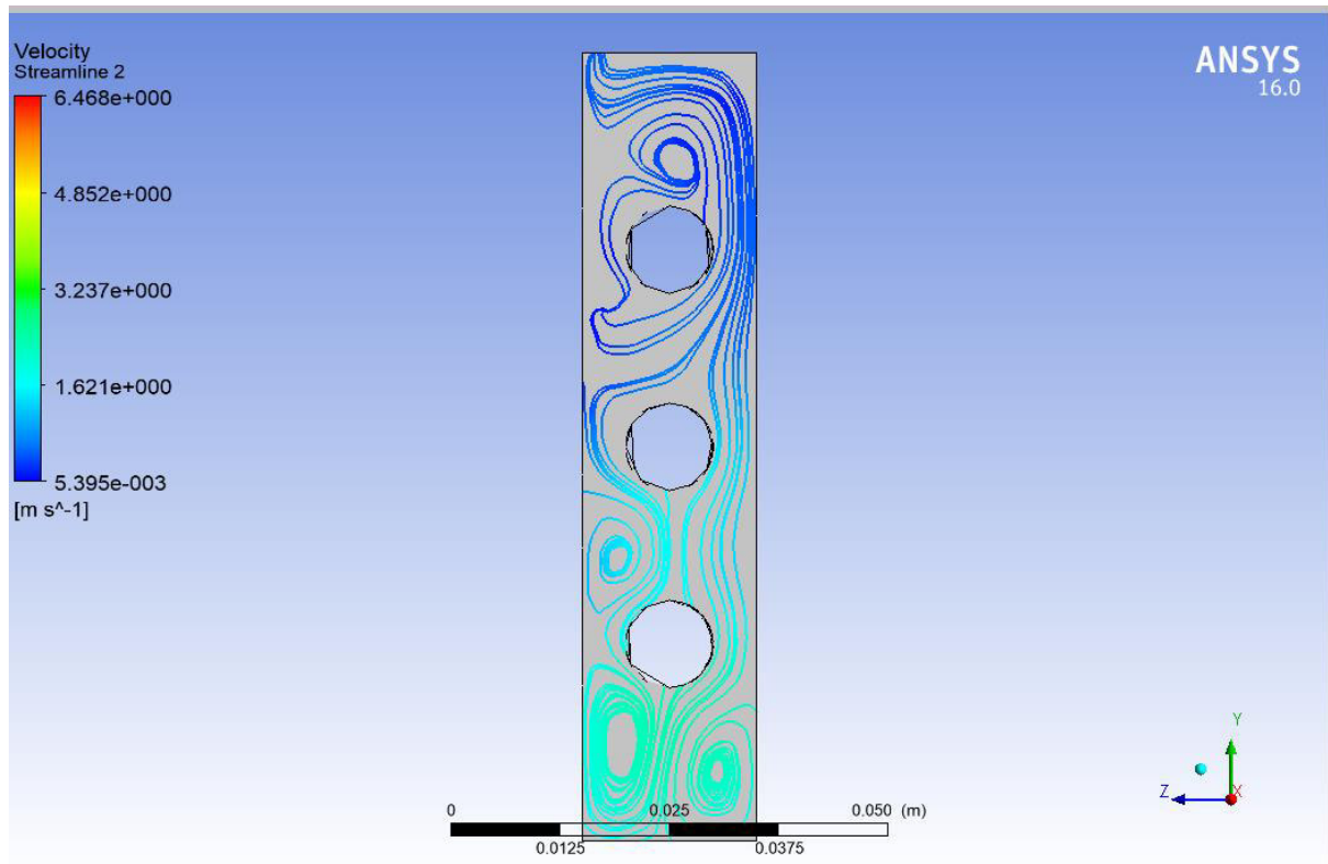
Figure 41: Lignes de courant d'eau dans la calandre
