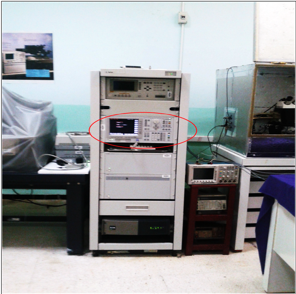
Figure 3. 3 : Schéma réel de l'analyseur des paramètres semi-conducteur Agilent 4156C
