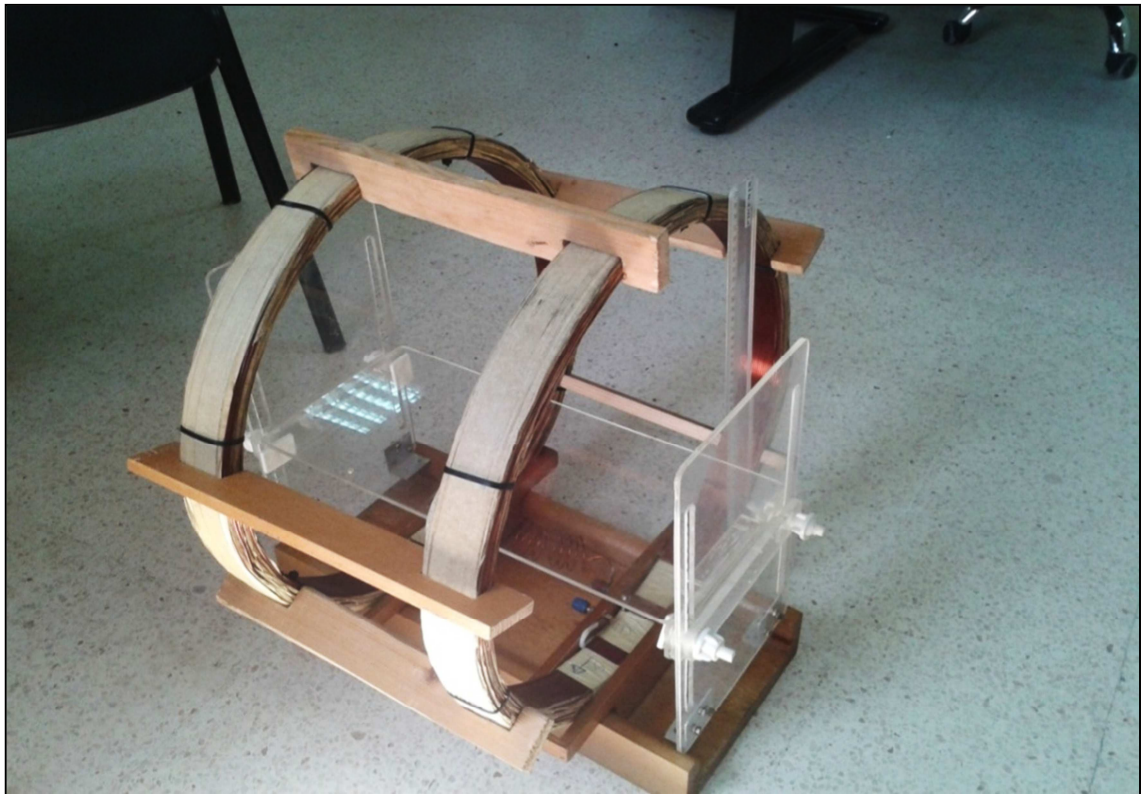
Figure 2. 13 : Bobine d'Helmholtz réalisée
