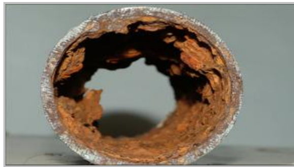
Figure III.1 MIC dans des réservoirs de stockage de liquide, ([D], 2010)
