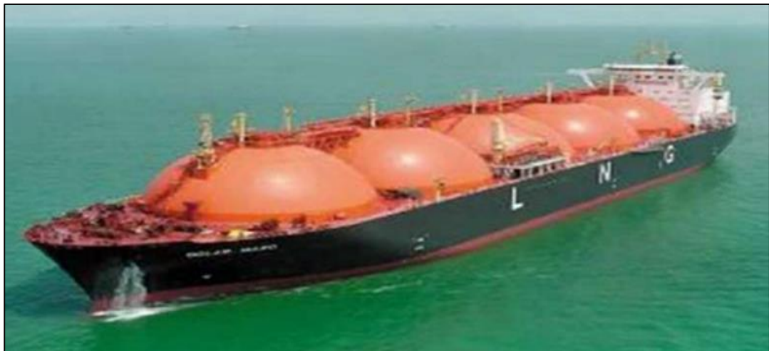
Figure I.8 : Transport du GNL : un méthanier à sphères.
