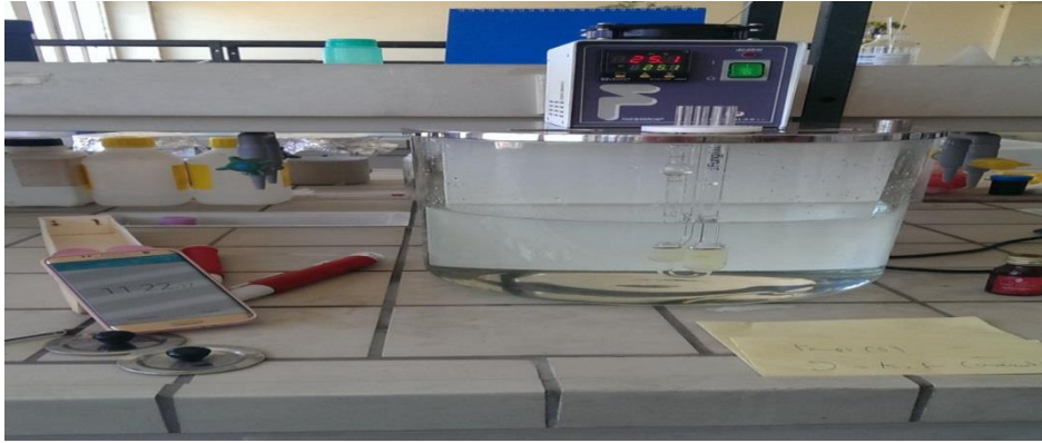
Figure 14 : mesure de viscosité cinématique d'huile de pépin de raisin avec le viscosimètre( Originale ).
