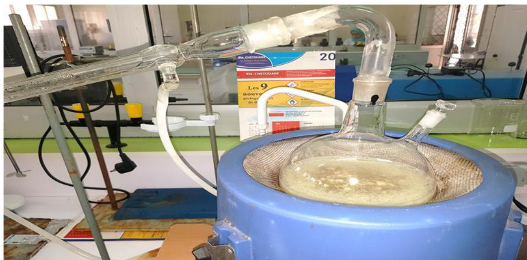
Figure 9: dispositif d'extraction de type de CLEVINGER( Originale ).
