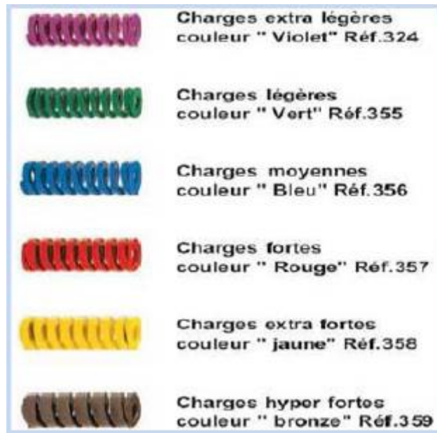
Figure 59 : Classification des ressorts par couleur
