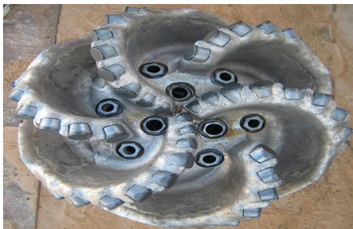
Fig I.2: OUTILS PDC SP619A
