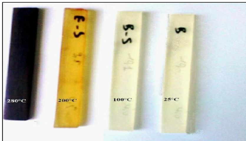
Figure IV.17. Evolution de la couleur des éprouvettes de résine en fonction du traitement thermique.
