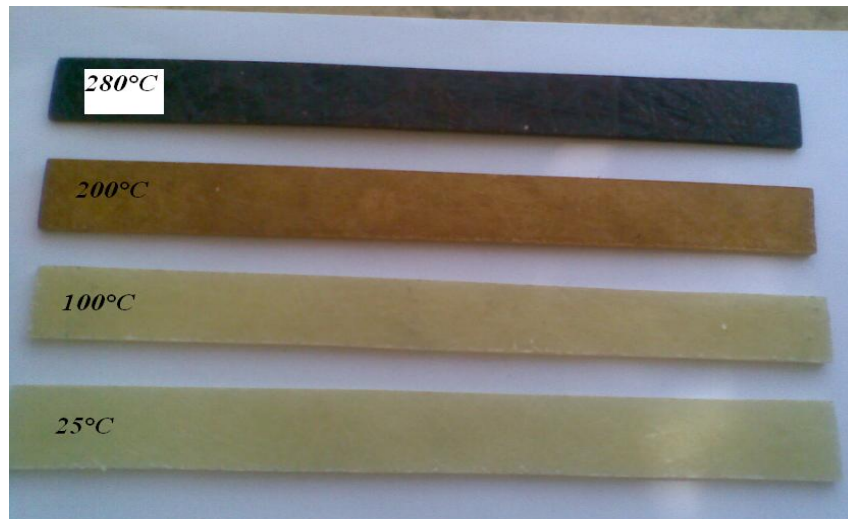
Figure IV.18. Evolution de la couleur des éprouvettes du composite en fonction du traitement thermique.
