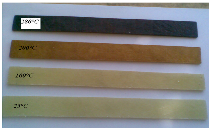
Figure IV.15. Evolution de la couleur des éprouvettes de résine en fonction du traitement thermique.
