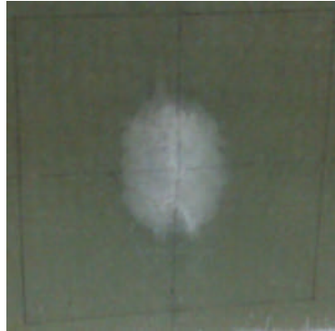
Figure III.15: Endommagement par impacts sur un composite verre/polyester.
