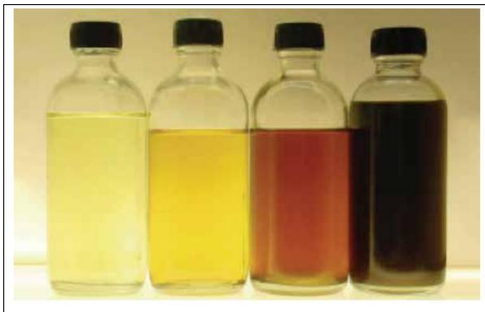
Figure IV.4: La décoloration progressive du fluide caloporteur due à l'oxydation [26]
