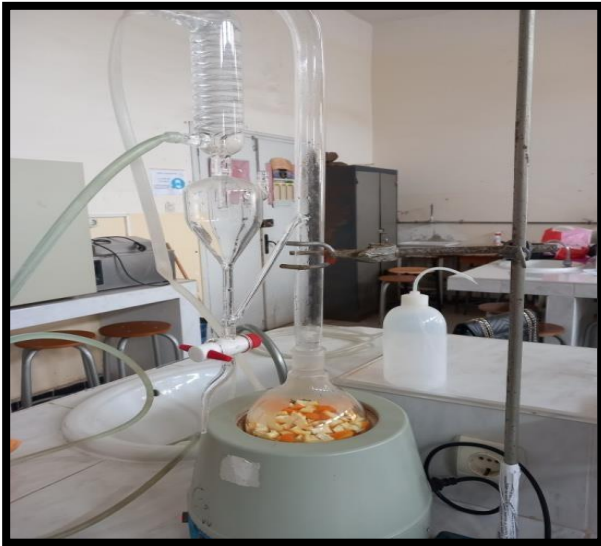
Photo n°1. Dispositif d'hydro distillation du type Clevenger contenant les écorces d'orange (Photo original 2023- Labo.2.32)
