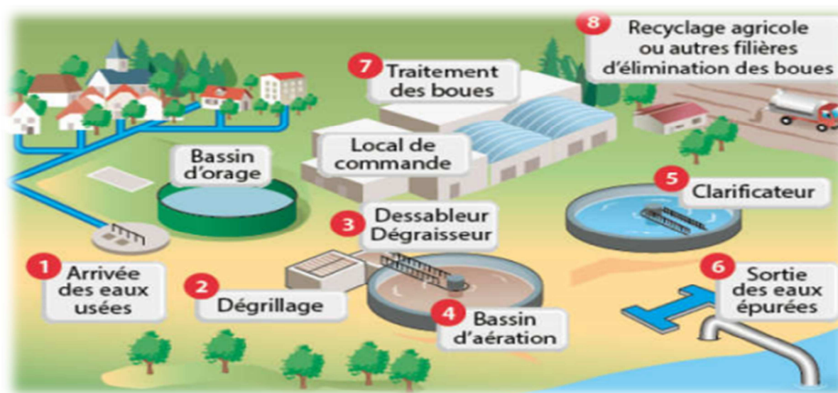
Figure III.1 : procédés d'épuration des eaux usées domestiques
