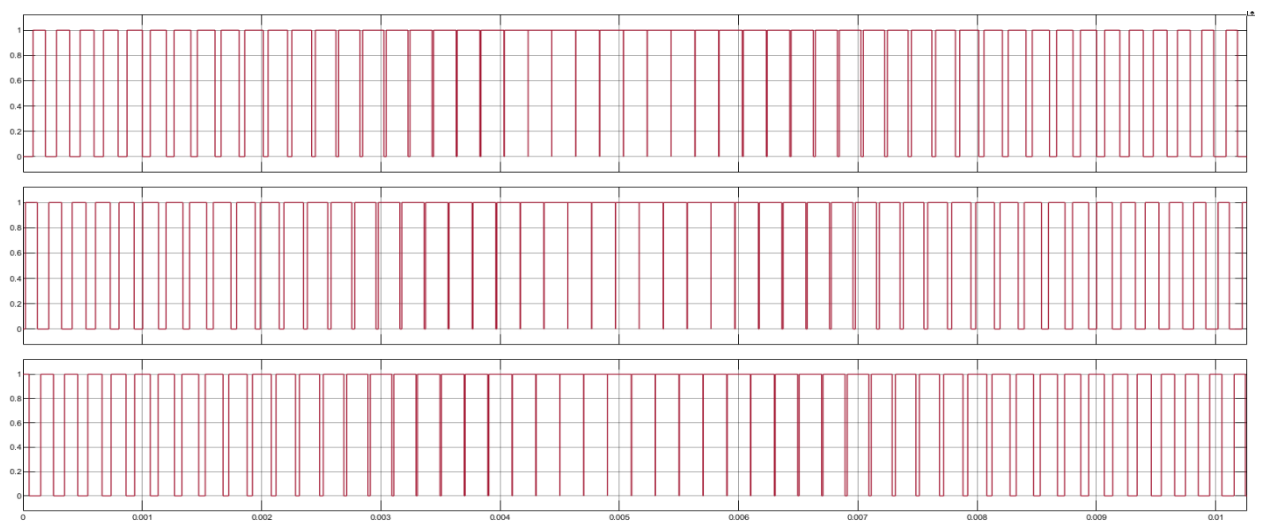
Figure III-5 Signaux de commande des interrupteurs superieur.
