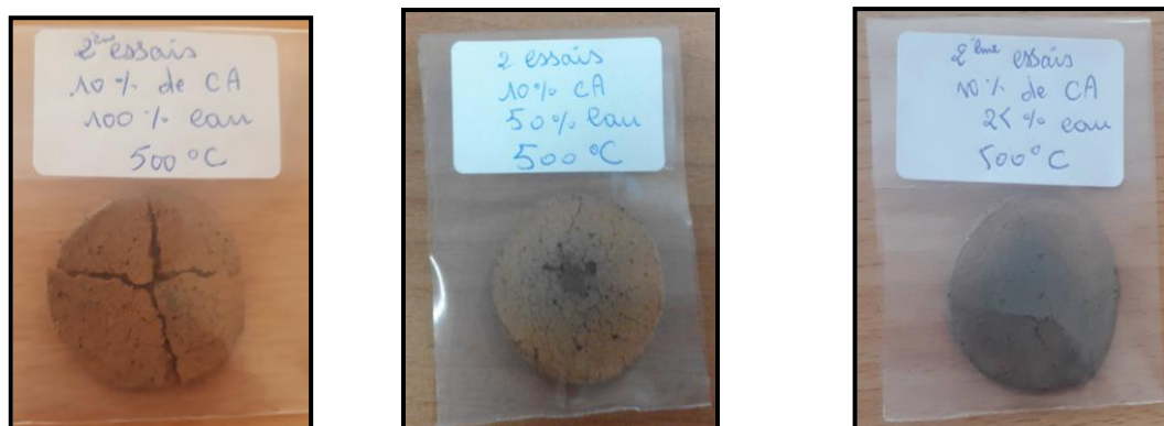
Figure III. 5 : Les pièces composites de l'essai 2 à 10% CA et température de cuisson 500°C.
