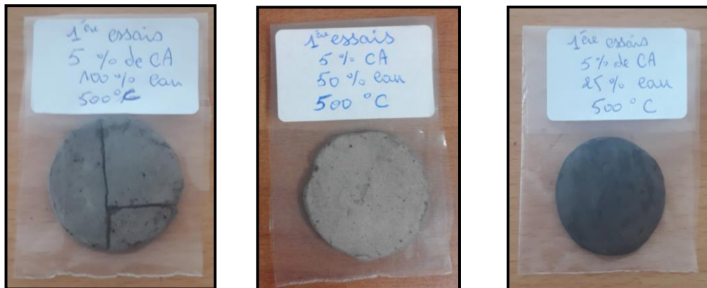
Figure III. 4 : Les pièces composites de l'essai 1 à 5% CA et température de cuisson 500°C.
