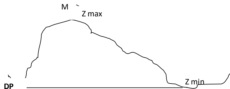
Fig.II.7 : Schéma d'un plan de référence horizontale
