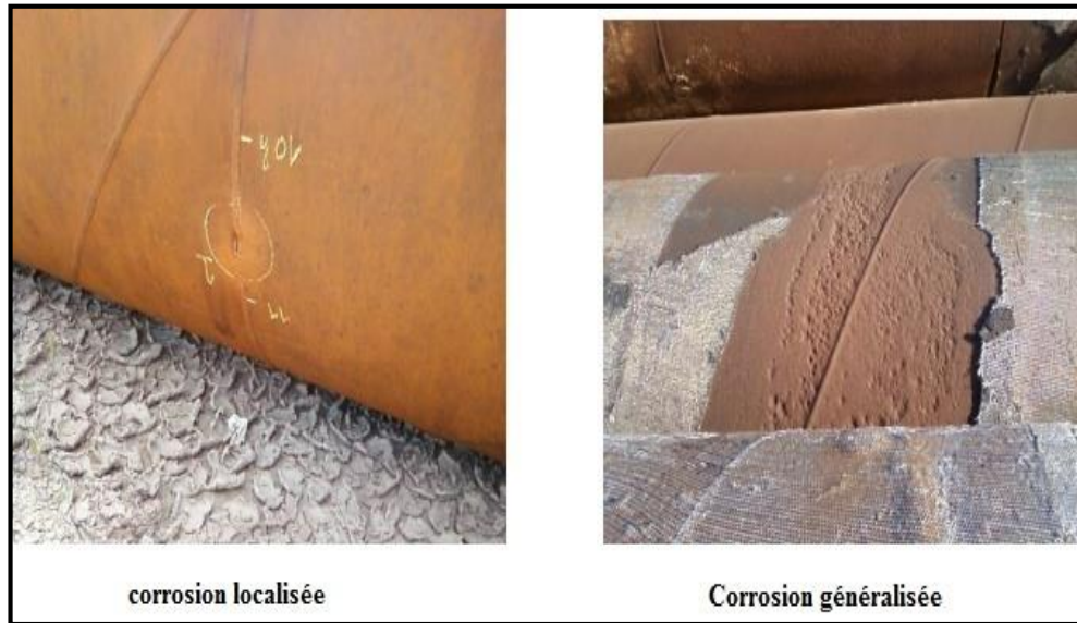
Fig. I.5 : Aspects de corrosion
