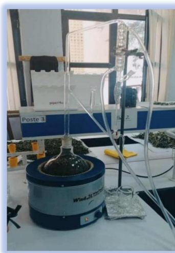
Figure 20 : Montage de l'hydrodistillation type Clevenger (photo originale, 2024).
