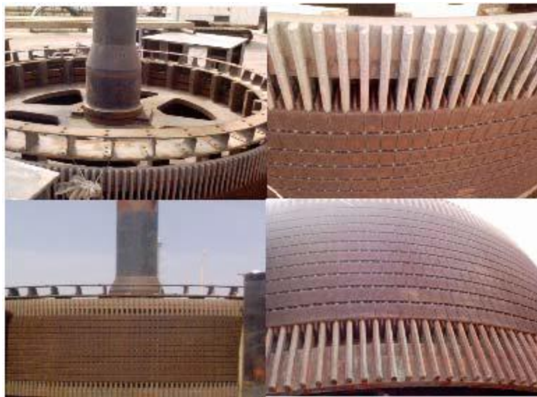
Figure II 17: Vue du rotor de la motopompe (EDM)
