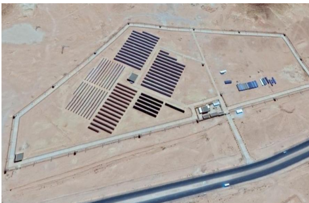
Figure III.2. Implantation des quatre technologies PV testées de la centrale solaire de Ghardaïa
