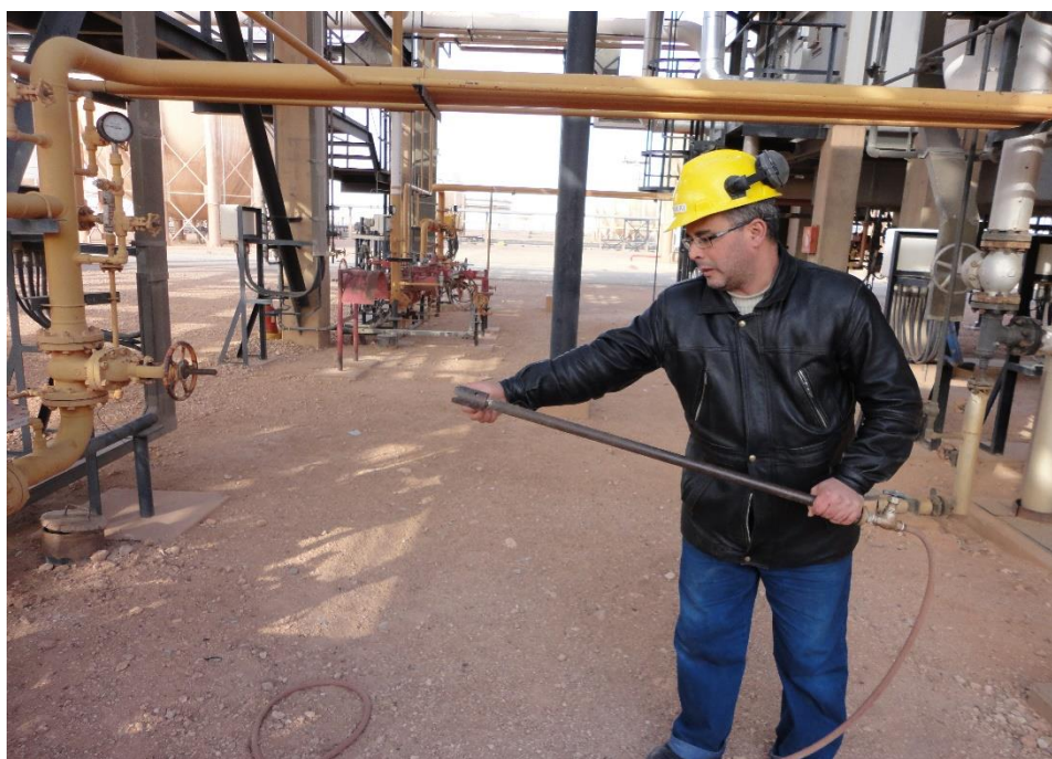
Figure II. 11 : Préparation de la torche d'allumage.
