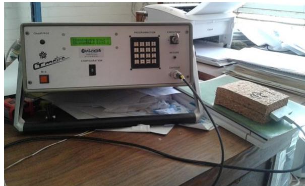
Figure 5.39. Mesure de la conductivité thermique du liège à l'aide d'un CT mètre.
