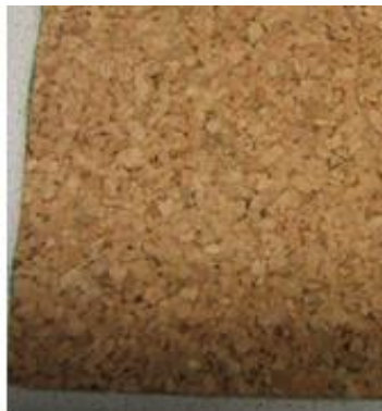
Figure 4.29. Lièges agglomérés de moyenne densité, granulé 3 à 5 mm.
