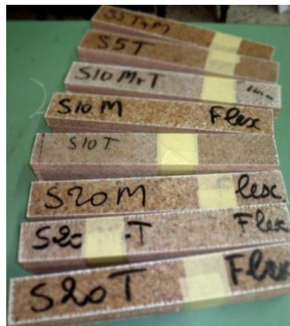
Figure 4.38. Éprouvettes découpées suivant la norme AFNOR NF T 54-606.
