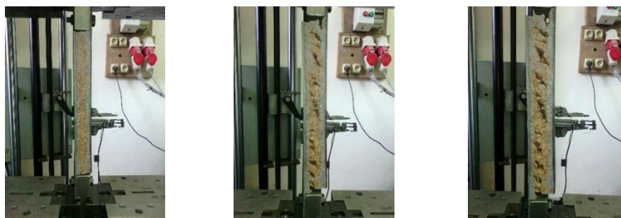
Figure 5.84. Evolution d'une structure sandwich sous l'effet de l'effort de cisaillement.
