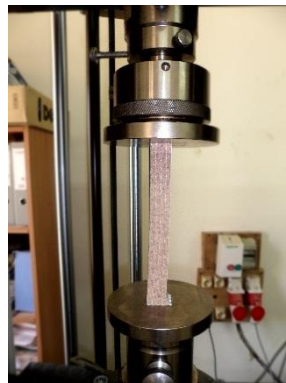
Figure 5.93. Mode de déformation de la structure sandwich après essai de compression longitudinal avec flambement.
