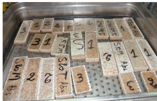
Figure 5.53. Détermination du pouvoir d'absorption d'eau des structures sandwichs.
