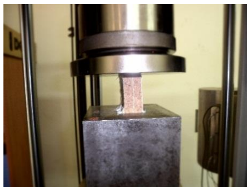
Figure 5.87. Mode de déformation de la structure sandwich après essai de compression longitudinal sans flambement.
