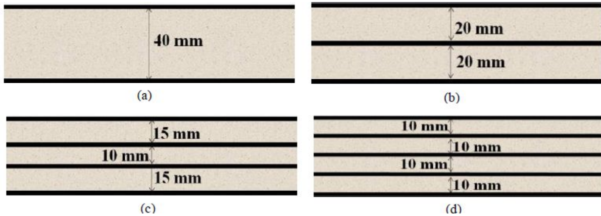
Figure II.2. Représentation schématique des assemblages des panneaux sandwichs : (a) SN40 ou SB40, (b) SN20 ou SB20, (c) SB15 ou SN15 et (d) SB10 ou SN10. [37]
