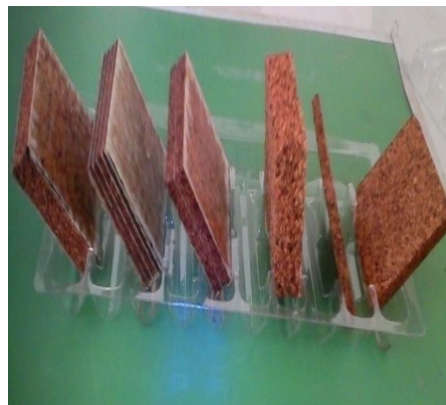
Figure IV.16. Egouttage des échantillons pendant 10 minutes.
