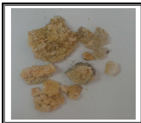
Dépôt prélevé des conduites intermédiaires des filtres -A.B-
