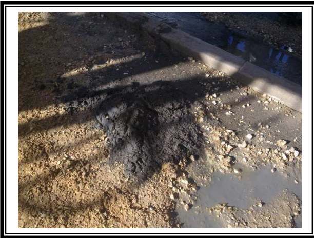
Figure 1.9: tamis dégradé enlevé du sommet des sécheurs
