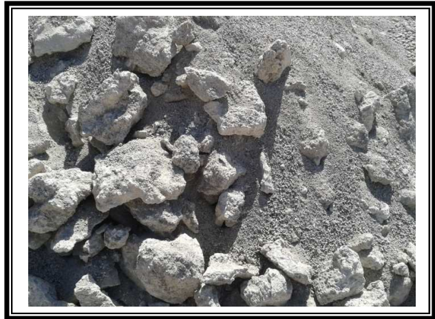
Figure 1.10: tamis dégradé enlevé du bas des sécheurs
