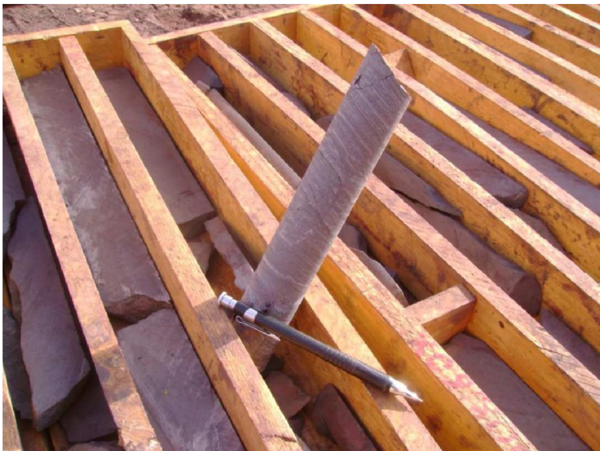
Figure 34 : Echantillon de BIF provenant du gisement de F'Dérrik qui montre l'alternance millimétrique de lits d'hématite (sombres) et de lits siliceux (clairs).
