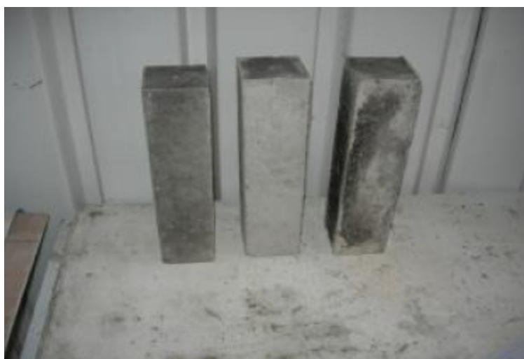
Figure 53 : Eprouvettes (10x10x40) cm.
