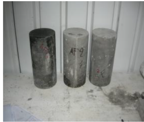
Figure 47 : Eprouvettes 11x22 cm.
