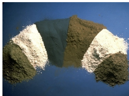
Figure 04 : Ajout cimentaires. De gauche à droite : cendres volantes (classe C), métakaolin (argile calcinée), fumée de silice, cendres volantes (classes F), laitier et schiste calciné.
