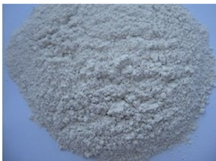
Figure 06 : Cendre volantes : une poudre ressemblant au ciment utilisé dans le béton.
