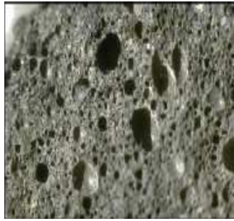
Figure 13 : Pouzzolane volcanique vu au microscope.
