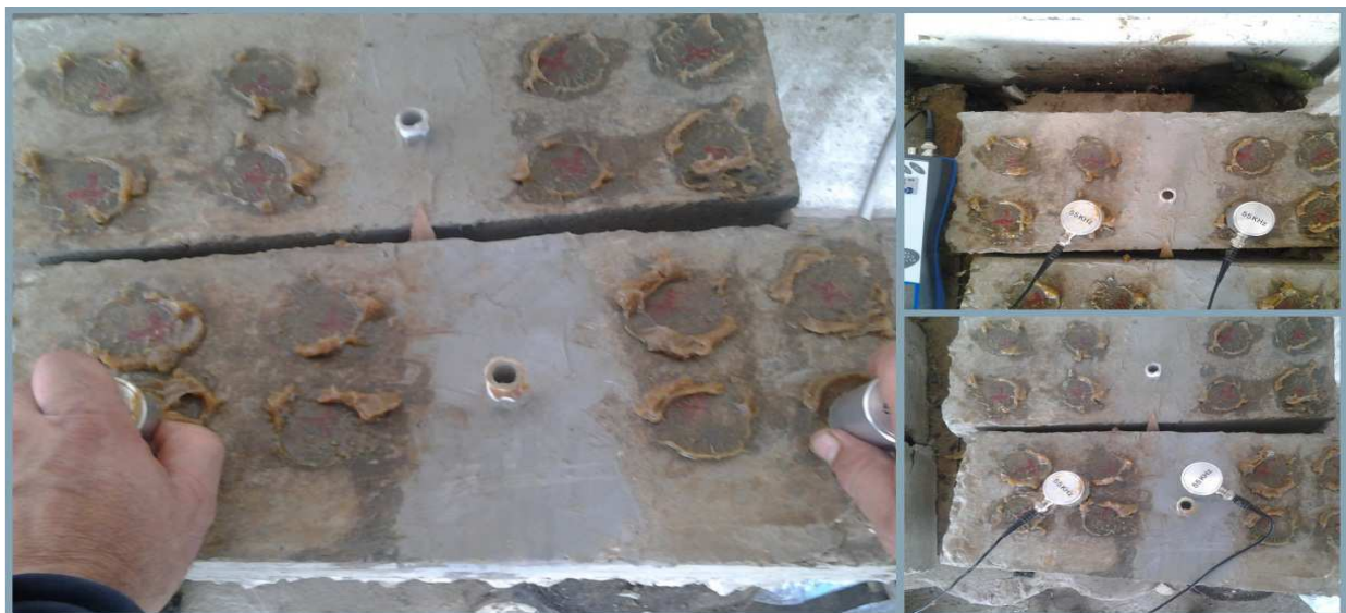
Figure-IV-11-Auscultation ultrasonores des éprouvettes réparées.
