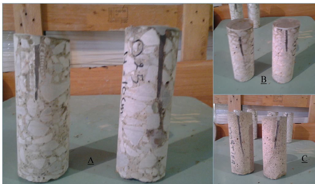
Figure-V-15-Carottes réparées à l'aide de l'injection.
