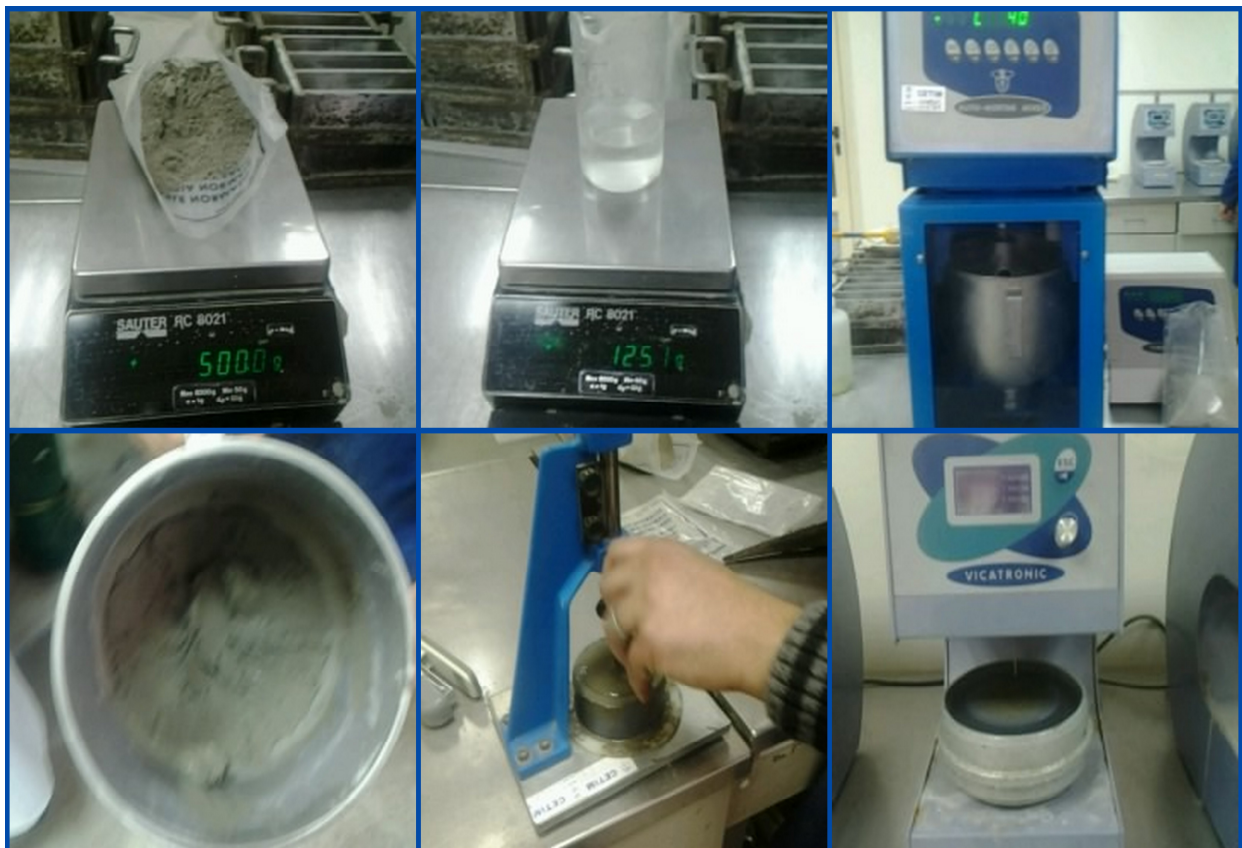
Figure IV-3- Essai de prise de ciment.
