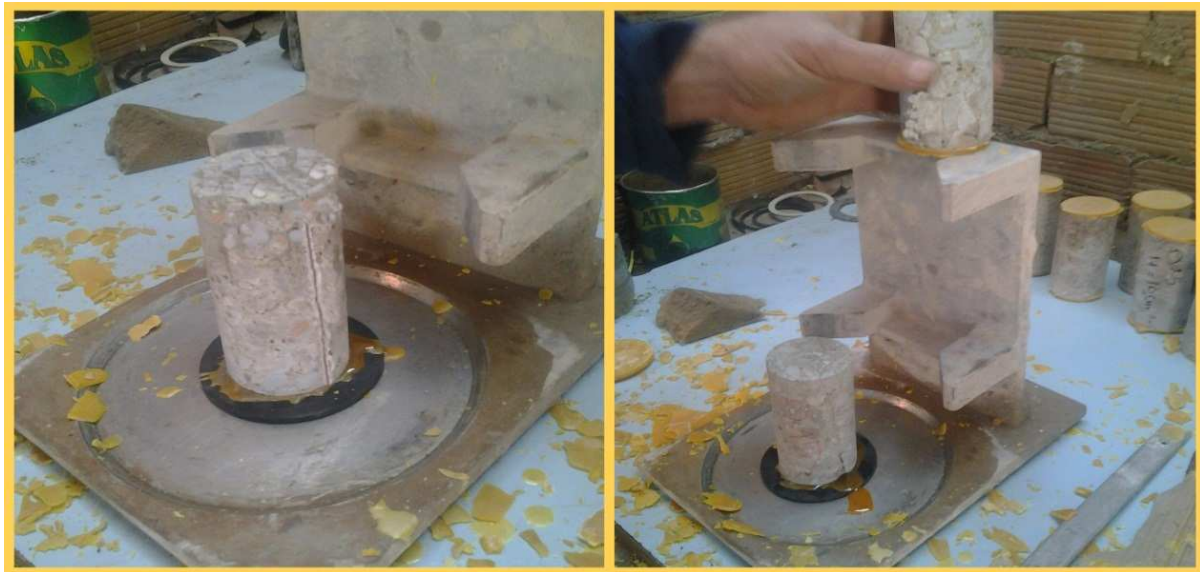
Figure-IV-7- Surfaçage des carottes normalisées.
