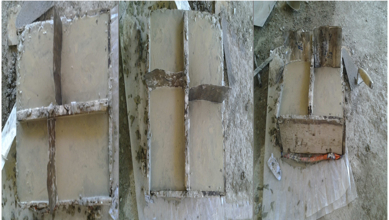
Figure IV-4- Confection des éprouvettes et création des fissures artificielles dans les bétons. (B 25 , B 15 , M).
