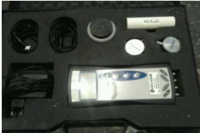
Figure-III-4- Appareil d'auscultation « Ultrason ».
