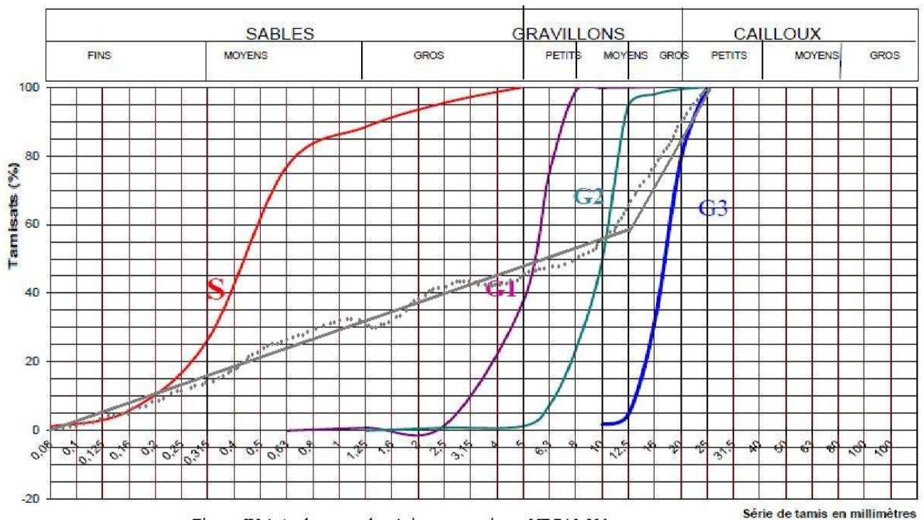
Figure-IV-1-Courbe granulométrique du béton B 25 .
