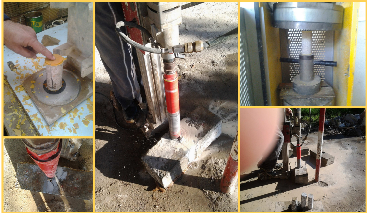
Figure-IV-12-Prélèvement, surfaçage et écrasement des carottes réparées.
