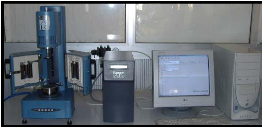
Figure IV .I : Image du Rhéomètre AR 2000
