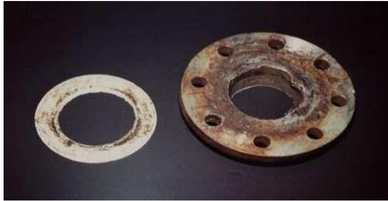
Figure I.5 : La corrosion caverneuse
