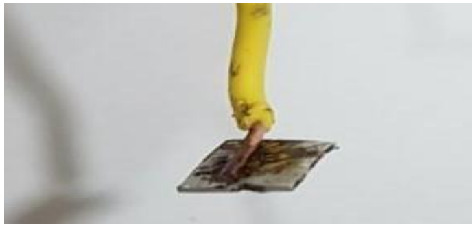
Figure II.5: une pièce d'aluminium soudée à un fil électrique.
