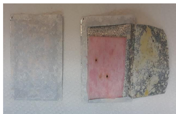
(b) Packaging d'une lingette imbibé par le réactif acidifié par HCl conservée pendant 3 Mois
