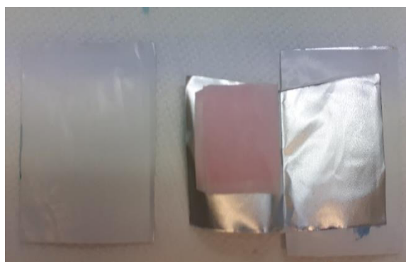
(a) Packaging d'une lingette imbibé par le réactif acidifié par \text{CH}_3\text{COOH} conservée pendant 3 Mois
