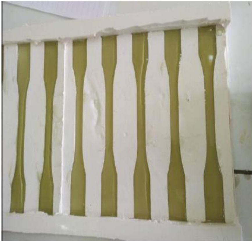
Figure II.1 : Moule normalisé utilisé pour fabriquer les éprouvettes pour le test de traction et flexion.
