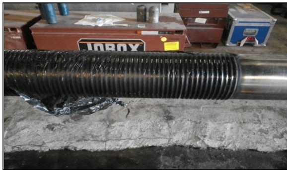
Fig.II 15.Photo réelle de la partie en caoutchouc du Casing Patch.
