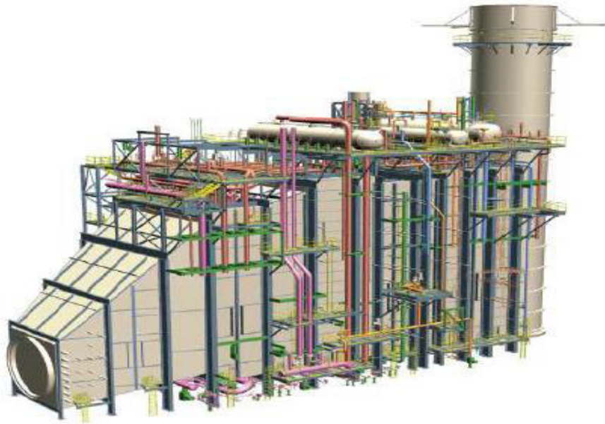
Figure III.3 : Chaudière de récupération
