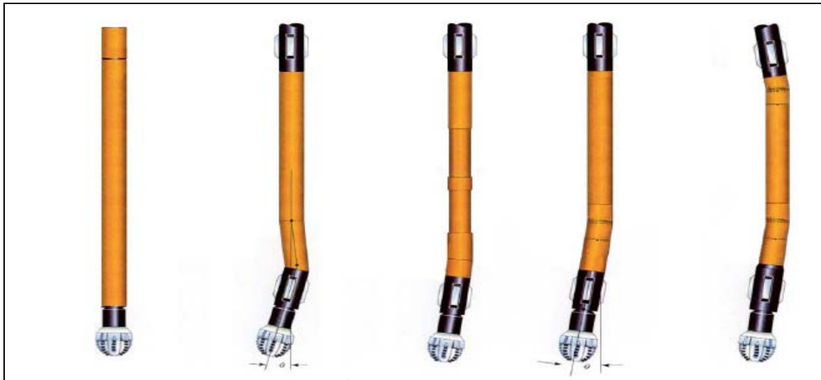
Fig(IV-4): Différentes géométries des PDM
