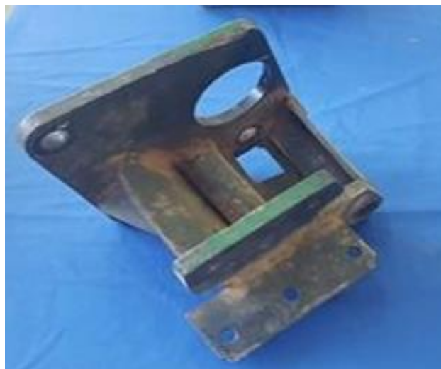
Figure II.6 : Support boîtier de direction en mécano-soudé.
