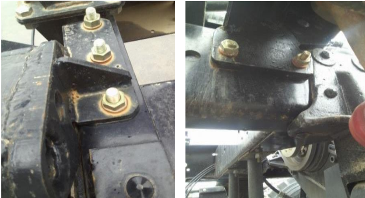
Figure II.7 : Fixation support boitier sur le châssis.
