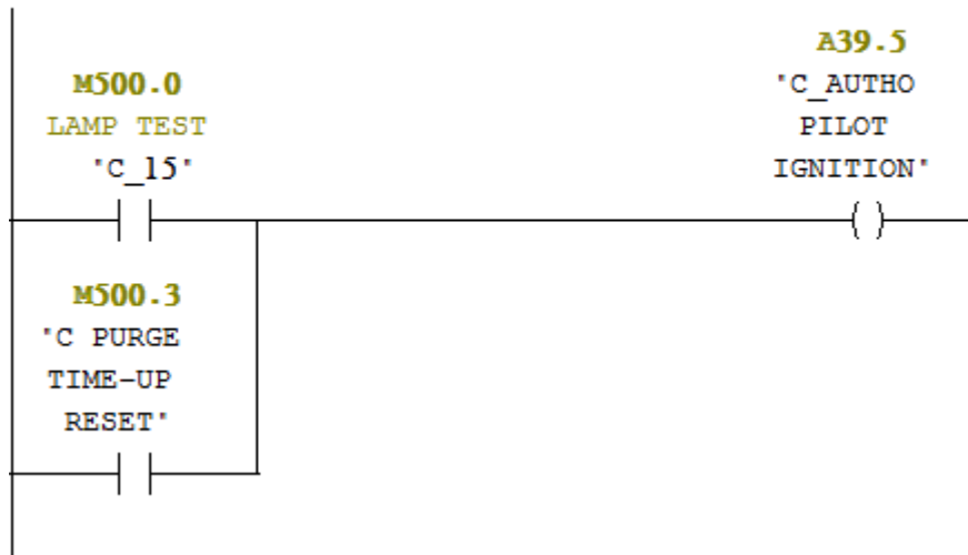
☐ Réseau 13: lamp témoin pilot ignition
