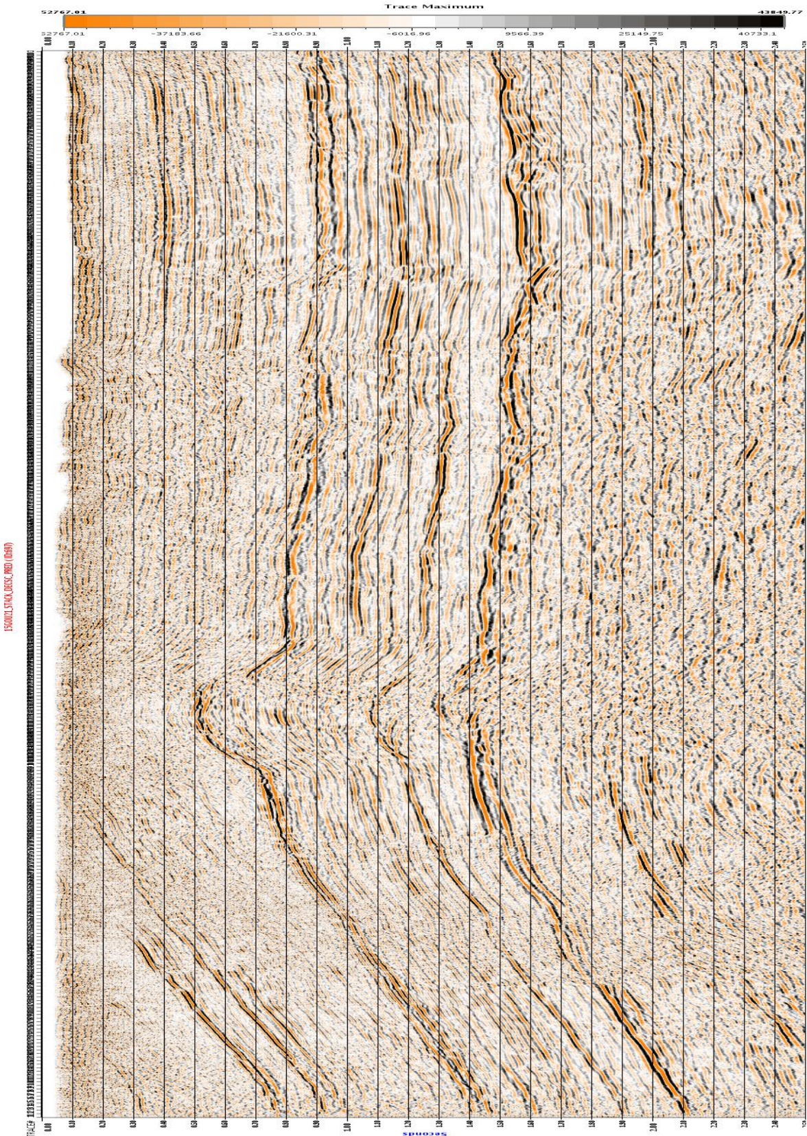
Figure III.35. Stack 1 (premier passage et déconvolution).
