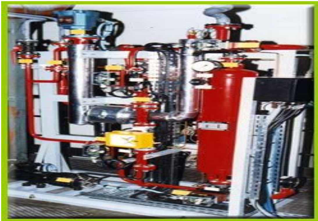
Figure I.4 : Sécheur d'hydrogène par adsorption
