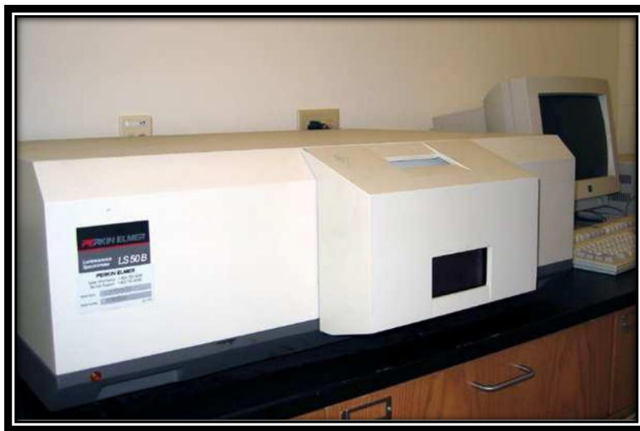
Figure .23 : Photographie du spectromètre de photoluminescence Perkin Elmer LS-50B du CRNA.
