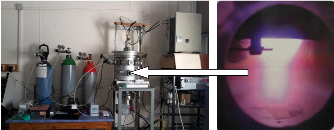
Figure .14 : Vue d'ensemble du pulvérisateur cathodique DC magnétron.
