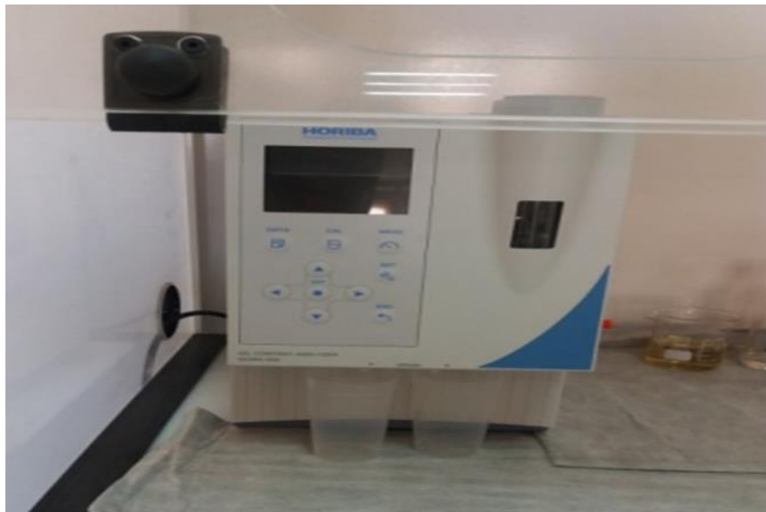
Annexe 6 : Analyseur d'hydrocarbures HORIBA OCMA-500 Teneur des hydrocarbures dans les eaux de rejets industriels
