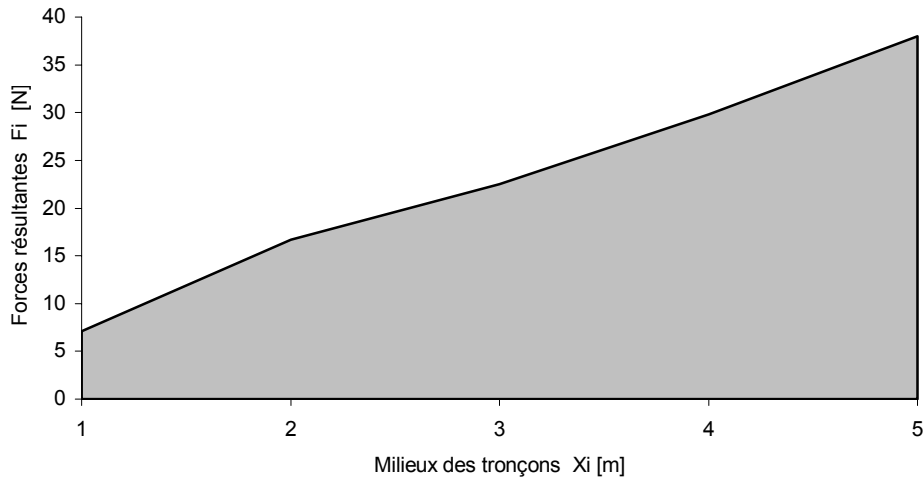
Fig. 6.14 : Epure de la force résultante F du flux, appliquée sur les tronçons de l'ailette [N]
