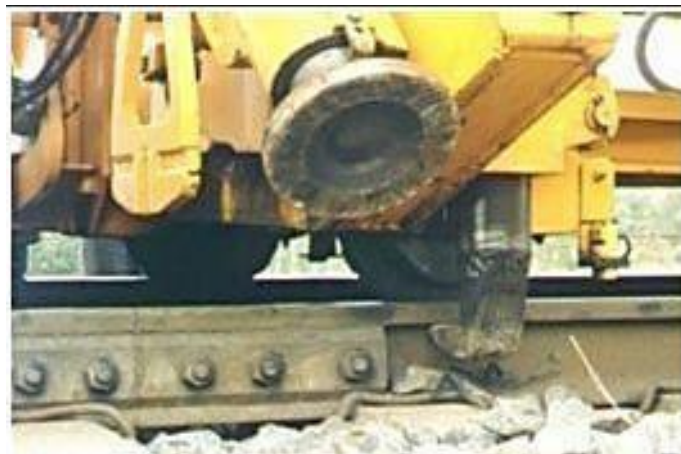
Figure III.7 : Unité de levage et d'alignement spécialisée présente sur les machines de bourrage universelles, [11].
