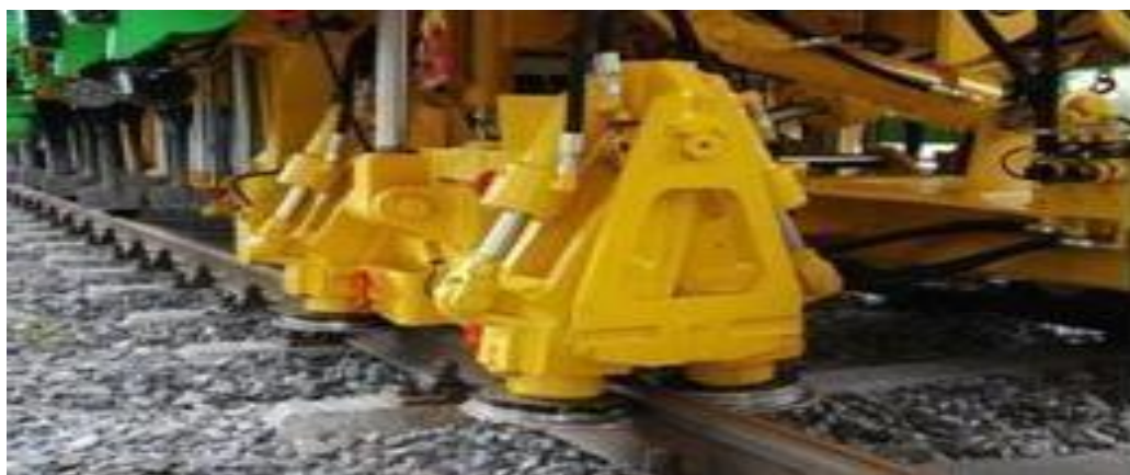
Figure III.9 : Une unité typique de levage et d'alignement trouvée sur des machines de bourrage sur une voie, [11].
