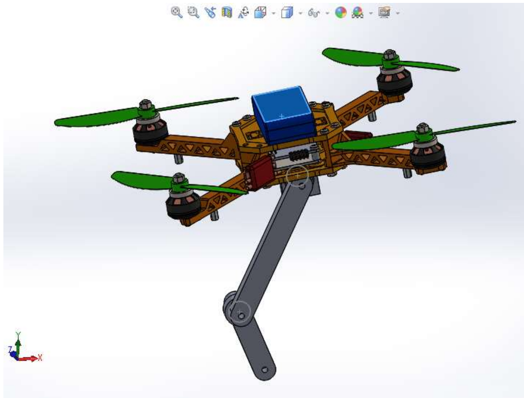
Figure 3.4. Modèle CAO du Quadri-manipulateur conçu sur le logiciel SolidWorks.
