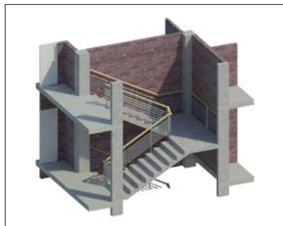
Figure II.5 : vue 3D d'un escalier à 2 volées
