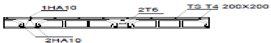
Figure III.13 : Schéma de ferrailage des planchers.
