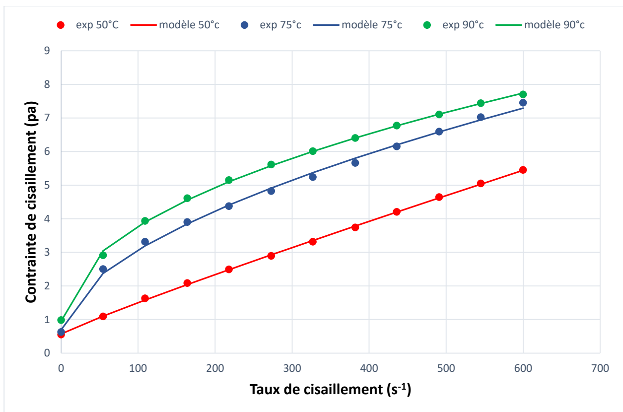
Figure [V.3] Modélisation du comportement rhéologique de fluide à différentes températures à partir du modèle d'Herschel-Bulkley
