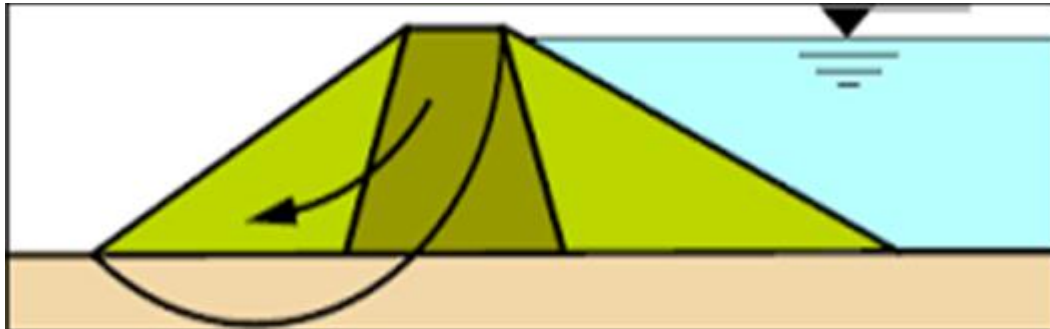
Figure I-17: Digues et barrages en terre
