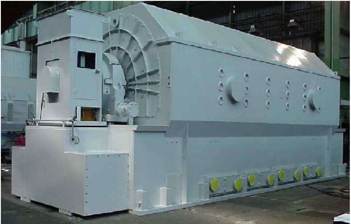
Figure I.10 alternateur de la centrale de LARBAA
