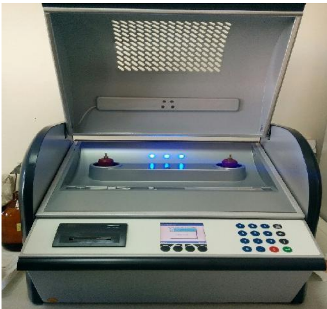
Figure IV.22 spintermètre BAUR OIL TESTER DTA.
