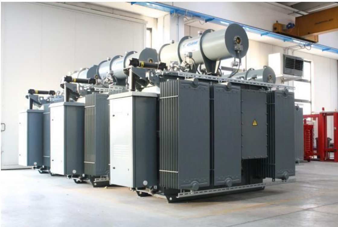
Figure II.8 transformateur à l'huile.
