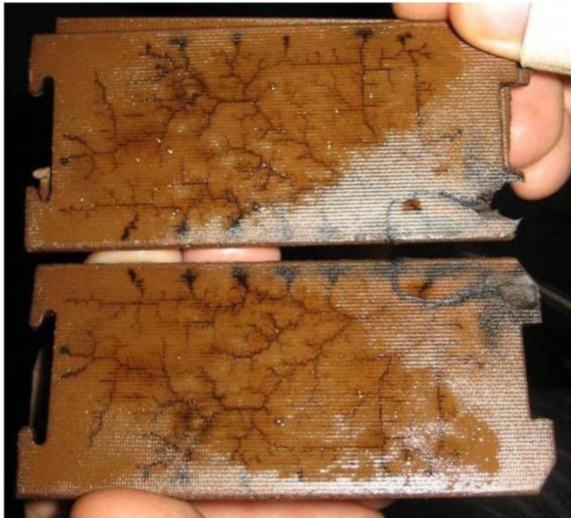
Figure III.3 Décharges partielles sur des cales.
