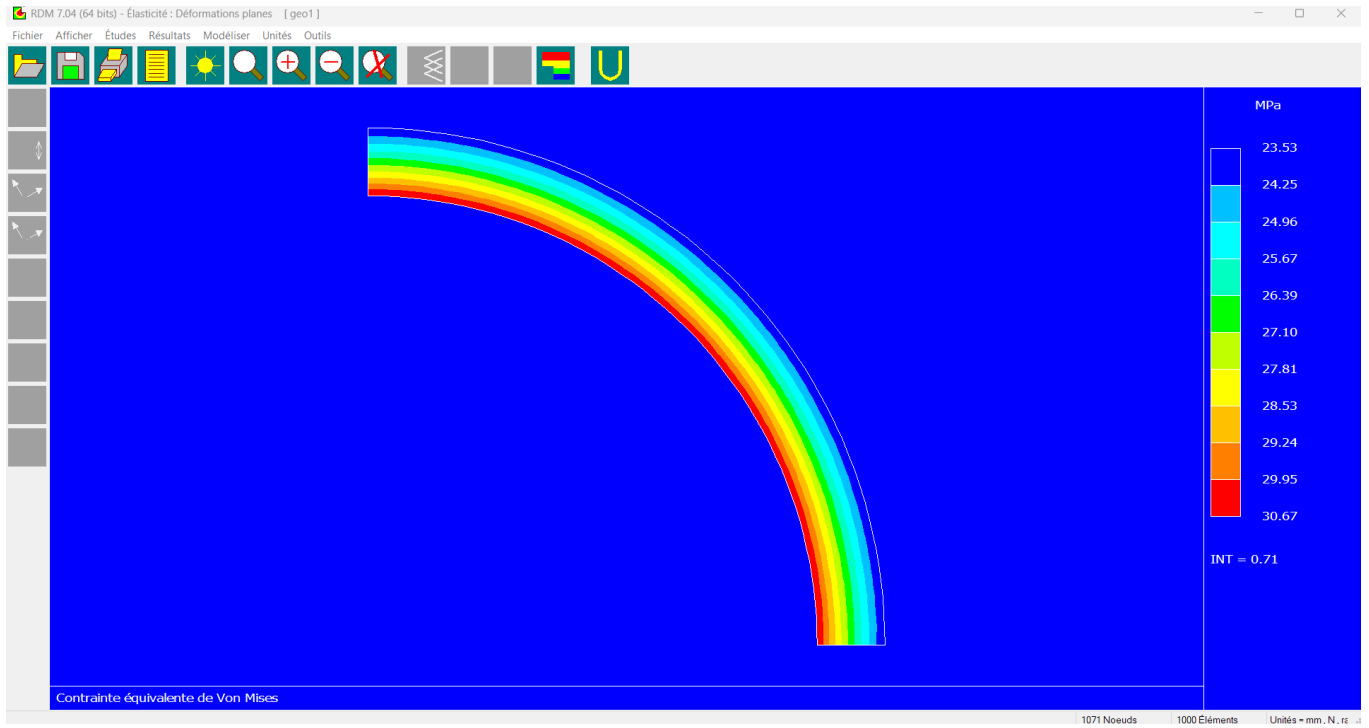
Figure IV. 13 : Contraintes de VON MISES dans le tube -Q4
