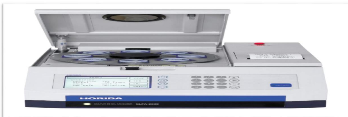
Figure IV. 4: L'appareil de mesure de la teneur en soufre.
