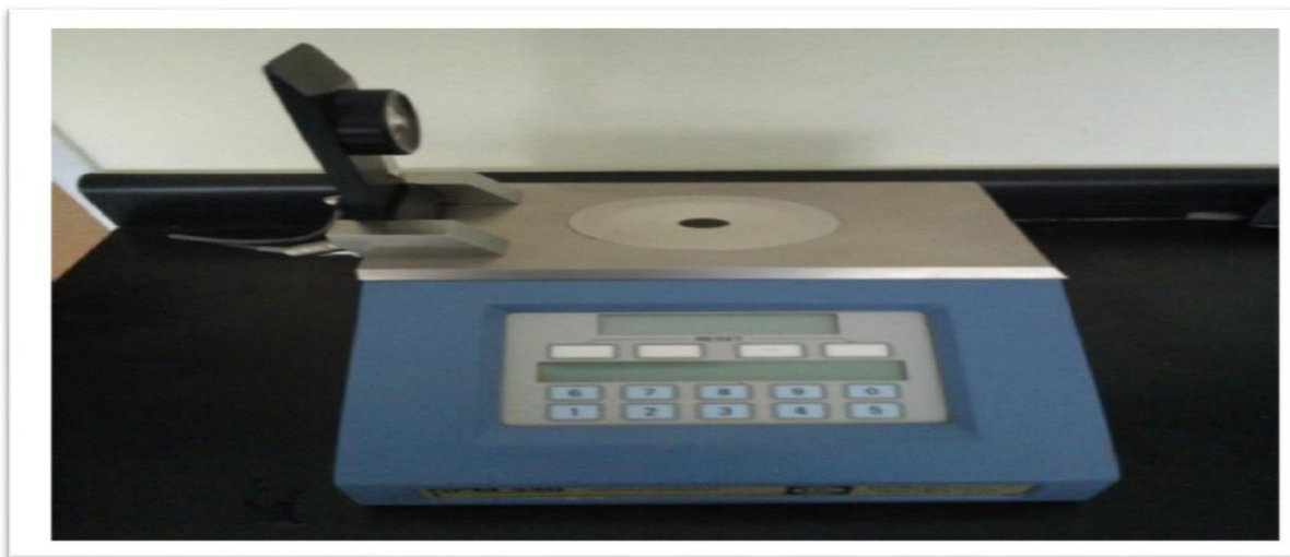
Figure IV. 8: L'appareil de mesure l'indice de réfraction.
