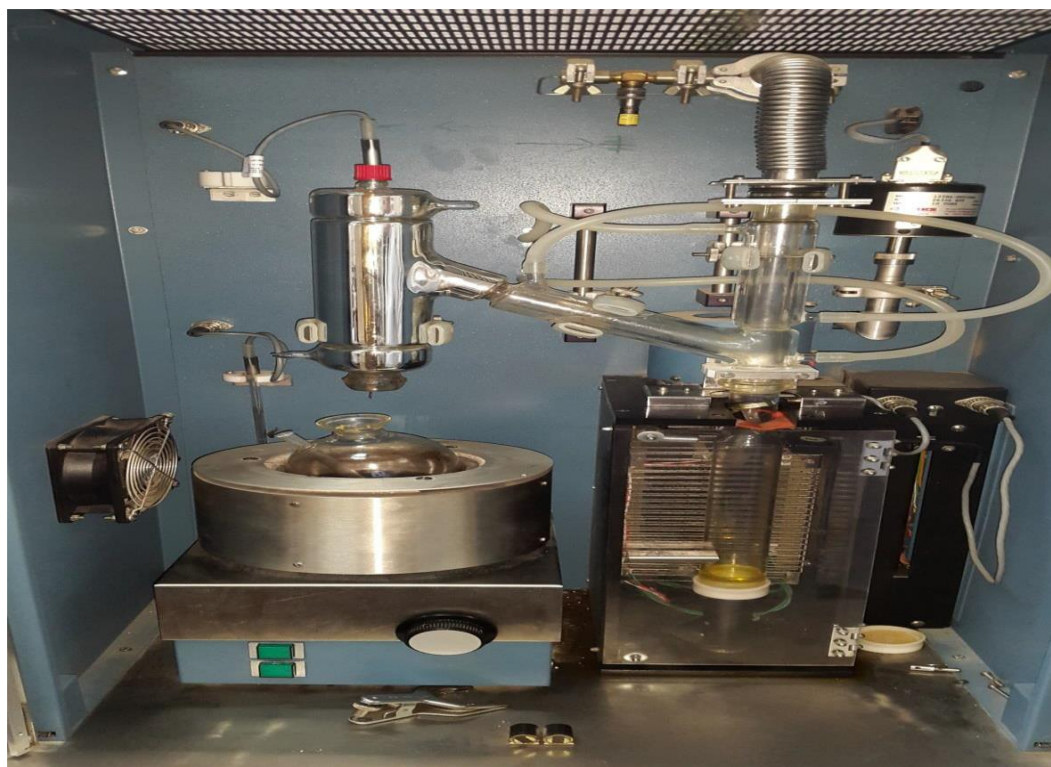
Figure IV. 16: Appareil semi-automatique de la distillation des produits pétroliers à pression réduite ASTM D1160.
