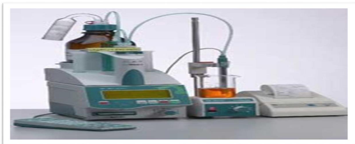
Figure IV. 12: Appareil pour détermination de l'indice d'acidité.
