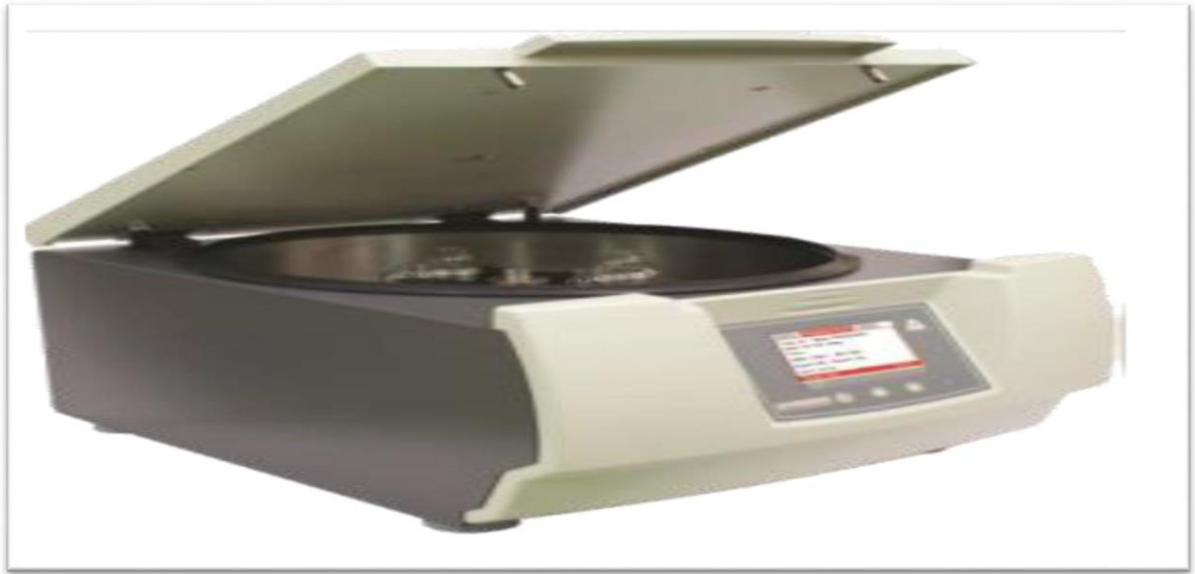
Figure IV. 10: L'appareil de mesure la teneur en eau et sédiment (BSW).
